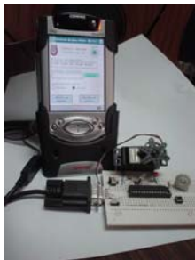
Fig. 8. Prototipo en operación con cuna de sincronización y PIC16F73 (sólo para comprobar compatibilidad).
