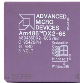
Fig. 1. Muestra una Microprocesador Amd modelo 486 (Un modelo 386 con Coprocesador Matemático (FPU))
